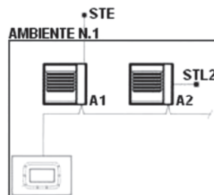
Entrambi gli apparecchi sono comandati da un unico quadro comandi remoto con la differenza che A2 è munito di una sonda di temperatura locale STL2 (optional) che comunica con il quadro comandi remoto per una modulazione di potenza dedicata. Inoltre la sonda di temperatura esterna STE (optional) permette un aggiustamento della potenza massima erogata da entrambi gli apparecchi.
