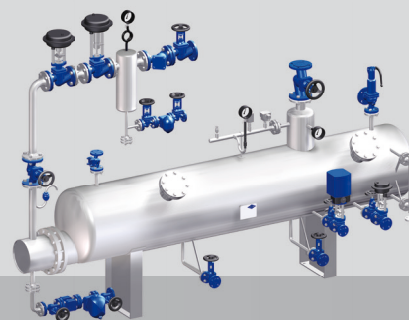
Generatori di vapore puro Per la sterilizzazione e l'umidificazione dell'aria, nonché per l'utilizzo nell'industria alimentare
