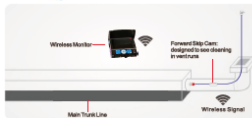
Pulizia dei condotti con trasmissione Wireless dell'immagine
