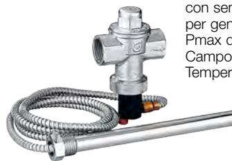
Valvola di scarico di sicurezza termica, con sensore a doppia sicurezza, per generatori a combustibile solido. Pmax di esercizio: 10 bar. Campo di temperatura: 5–110 °C. Temperatura di taratura 98 °C (0/-4 °C).
