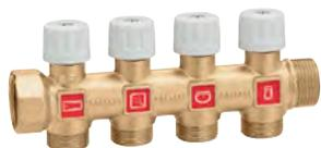
Collettore semplice, componibile con valvole di intercettazione. Corpo in lega antidezincificazione CR. Pmax di esercizio: 10 bar. Campo di temperatura: 5-100 °C.
