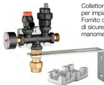
Collettore portastrumenti in tecnopolimero per impianti di riscaldamento. Fornito di valvola sfogo aria, valvola di sicurezza in tecnopolimero, manometro, rubinetto automatico di intercettazione per vasi d'espansione e staffe di fissaggio. **Con coibentazione.** Campo di temperatura: 5-90 °C. Fino a 50 kW.
