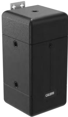
Con coibentazione in PPE espanso ad elevato isolamento termico. Pmax di esercizio: 4 bar. Max percentuale di glicole: 30 %. Campo di temperatura: -10-95 °C (senza formazione di ghiaccio).
