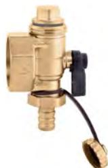
Gruppo di testa di ritorno composto da raccordo a doppio attacco radiale con valvola a sfera a tre posizioni, attacco by-pass con tappo e portagomma di carico/scarico. Pmax di esercizio: 10 bar. Campo di temperatura: 0-100 °C.
