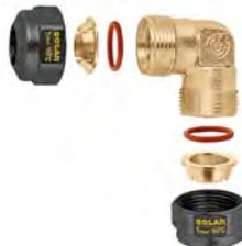
Raccordo curvo, meccanico a tenuta O-Ring per impianti solari. Per tubi in rame ricotto, rame crudo, ottone, acciaio dolce e acciaio inox. Pmax di esercizio: 16 bar.
