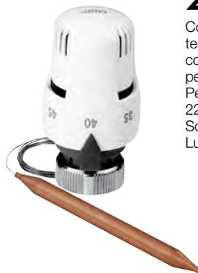
Comando termostatico per valvole radiatori termostattizzabili e termostatiche, con sonda a contatto, per limitazione di temperatura del fluido. Per valvole serie 338, 339, 401, 402, 455, 220, 221, 222, 223, 224, 225, 226 e 227. Scala temperatura impostata. Lunghezza del tubo capillare: 2 metri.
