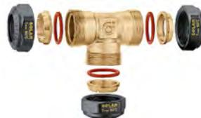
Raccordo a tee, meccanico a tenuta O-Ring per impianti solari. Per tubi in rame ricotto, rame crudo, ottone, acciaio dolce e acciaio inox. Pmax di esercizio: 16 bar.
