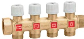
Collettore semplice, componibile con valvole di intercettazione. Corpo in ottone. Pmax di esercizio: 10 bar. Campo di temperatura: 5-100 °C. Con derivazioni sede piana. **Per raccordi a pressare.**
