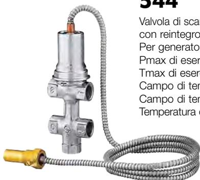
Valvola di scarico termico, ad azione positiva, con reintegro incorporato. Per generatori a combustibile solido. Pmax di esercizio: 6 bar. Tmax di esercizio: 110 °C. Campo di temperatura: 5-110 °C. Campo di temperatura ambiente: 1-50 °C. Temperatura di taratura: 100 °C (0/-5 °C).
