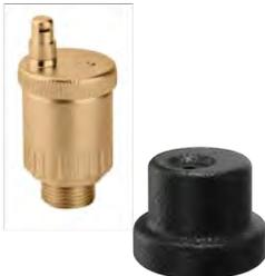
Valvola automatica di sfogo aria. In ottone stampato. Con tappo igroscopico di sicurezza. Con coibentazione. Pmax di esercizio: 10 bar. Pmax di scarico: 2,5 bar. Tmax di esercizio: 120 °C.
