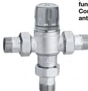
Miscelatore termostatico regolabile con manopola, **con valvole di ritegno e filtri.** Specifico per controllo temperatura al punto di distribuzione, **completo di funzione chiusura termica. Corpo in lega "LOW LEAD" antidezincificazione CR.** Cromato. Pmax di esercizio: 10 bar. Tmax ingresso: 90 °C. **Certificato a norma EN 15092.** PATENT.
