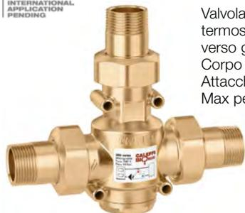
Valvola anticondensa con controllo termostatico della temperatura di ritorno verso generatori a combustibile solido. Corpo in ottone. Attacchi maschio a bocchettone. Max percentuale di glicole: 50 %. Pmax di esercizio: 10 bar. Campo di temperatura: 5-100 °C. Tarature (Tset): 45 °C, 55 °C, 60 °C, 70 °C. Precisione taratura: ± 2 °C. Temperatura di chiusura completa by-pass: Tmix = Tset +10 °C = Tr.
