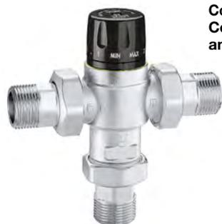
Miscelatore termostatico regolabile con manopola. Per controllo temperatura al punto di distribuzione. **Completo di funzione chiusura termica. Corpo in lega "LOW LEAD" antidezincificazione CR.** Cromato. Pmax di esercizio: 10 bar. Tmax ingresso: 90 °C. PATENT.
