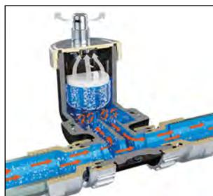
Grazie a questi mini-vortici, le microbolle di aria presenti nel flusso si separano, si raccolgono nella parte inferiore della camera, e dopo essersi aggregate in bolle più grandi risalgono verso l'alto attraverso dei condotti di scarico posti a lato del galleggiante. Una volta raggiunta la sommità della valvola, le bolle aggregate spingono il galleggiante verso il basso provocando l'apertura della valvola sfogo aria e il conseguente scarico dell'aria.
