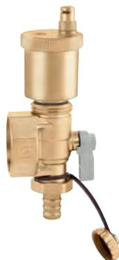
Gruppo di testa di mandata composto da raccordo a doppio attacco radiale con valvola a sfera a due posizioni, valvola sfogo aria automatica con tappino igroscopico e portagomma di carico/scarico. Pmax di esercizio: 10 bar. Pmax di scarico: 2,5 bar. Campo di temperatura: 0-100 °C.
