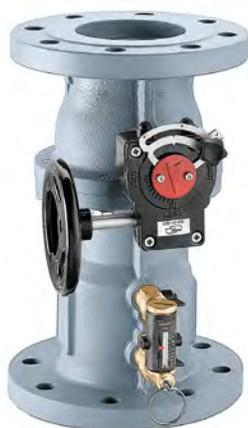
Valvola di bilanciamento con flussometro. Lettura diretta della portata. Corpo in ghisa. Flussometro in ottone. Valvola a sfera per regolazione portata con interno sagomato. Flussometro a scala graduata con indicatore portata a movimento magnetico.
