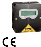
Termostato con display visualizzazione temperatura bollitore. Per dispositivi serie 264 e 265. Alimentazione: 230 V (AC). Campo di temperatura regolabile: 25-50 °C. Taratura di fabbrica: 45 °C. Grado di protezione scatola: IP 54.
