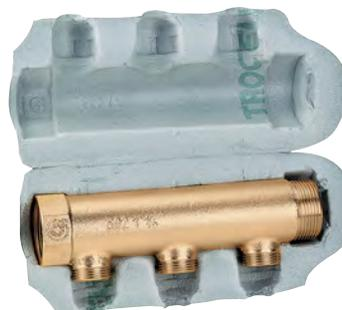
Collettore semplice componibile. Per impianti di condizionamento. **Con coibentazione.** Pmax di esercizio: 10 bar. Campo di temperatura: -40-95 °C.
