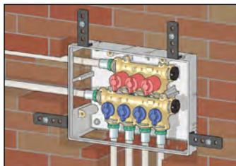
Utilizzare l'apposito coperchio di protezione prima di procedere con l'intonacatura della parete. Al termine dell'operazione rimuovere il coperchio di protezione. La cassetta si troverà allineata a filo muro.
