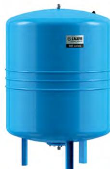
Vaso di espansione saldato, per impianti sanitari, certificato CE. Membrana a vescica (sostituibile per volumi da 60 a 500 l). Pmax di esercizio: 10 bar. Campo di temperatura sistema: -10-70 °C. Campo di temperatura membrana: -10-70 °C. Conforme a norma EN 13831. Conforme al D.M. 6 Aprile 2004, no.174.
