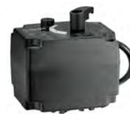
Servomotore per valvole miscelatrici codici 610.00 da 1/2" a 2". Alimentazione: 24 V. Segnale di comando: 0(2)-10 V, 0(4)-20 mA, 0-5 V, 5-10 V. Segnale di feedback: 0-10 V. Assorbimento: 2 W. Grado di protezione: IP 44. Rotazione 90°. Tempo di manovra: 75 s. Campo di temperatura ambiente: 0-55 °C. Campo di temperatura di stoccaggio: -10-70 °C. Lunghezza cavo di alimentazione: 1,5 m.
