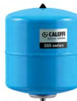
Vaso di espansione saldato, per impianti sanitari, certificato CE. Membrana a vescica. Pmax di esercizio: 10 bar. Campo di temperatura sistema: -10-70 °C. Campo di temperatura membrana: -10-70 °C. Conforme a norma EN 13831. Conforme al D.M. 6 Aprile 2004, no.174.
